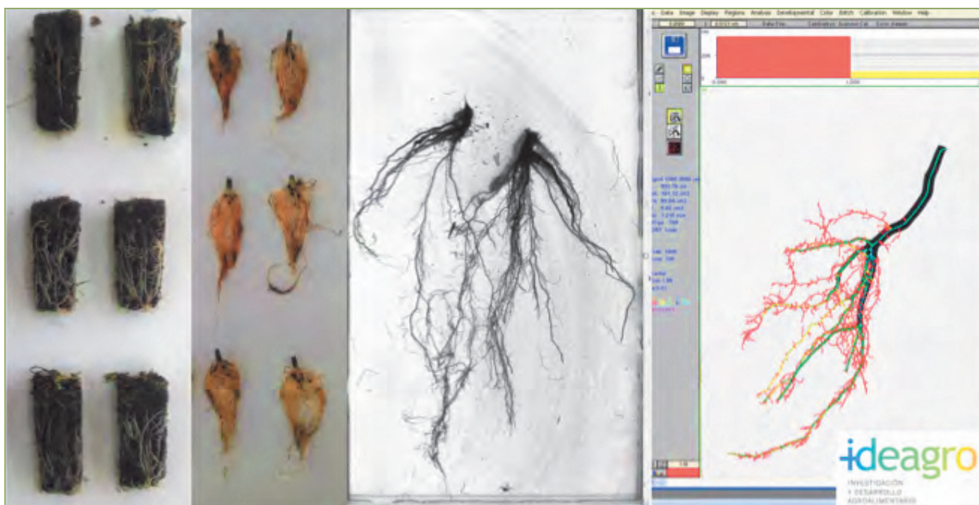
Foto 3. Medición de volumen, longitud, área y diámetro radicular mediante programa de tratamiento de imágenes (WinRHIZO).
