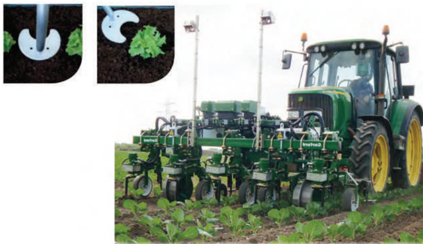
Figura 12. Equipo Robocrop para el control mecánico de las hierbas tanto en la línea como en las entrelíneas.
