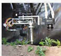
Figura 13. Escardador robótico inteligente Bonirob.
